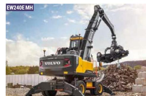
stabilisateurs pour une entrée et sortie aisées de la cabine, laquelle peut se lever jusqu'à 5 mètres. Un manipulateur de direction sécurisé permet de diriger la pelle à l'aide du joystick jusqu'à une vitesse 19 km/h. Avec son solide moteur 6 cylindres, le ralenti et arrêt automatique du moteur, et le mode ECO, la machine est prête à braver les sollicitations les plus fortes, tout en maîtrisant au mieux la consommation.
