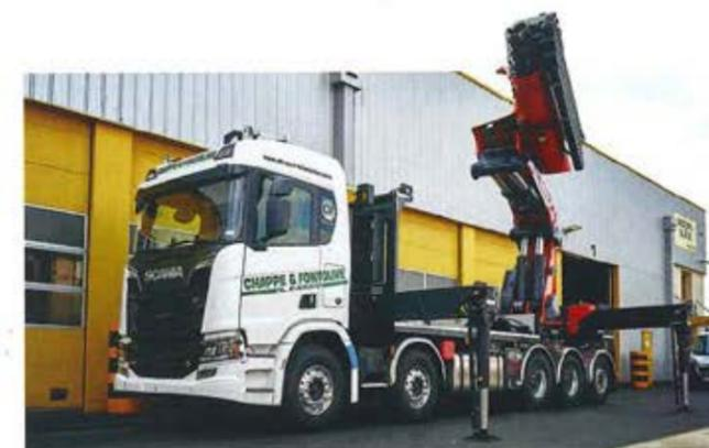
Fontolive soulève 5 700kg à 18,5 mètres. Elle est équipée d'un fly jib (bras articulé supplémentaire) qui augmente sa portée à 31m et même à plus de 33m grâce à une extension manuelle supplémentaire ! L'ensemble est aussi doté d'un treuil amovible de 3,4 T qui se monte en lieu et place du fly fib.
