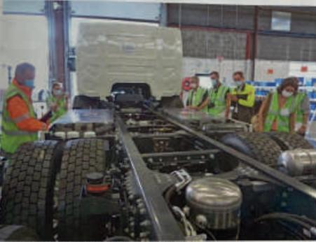
**Le pack d'électronique de puissance et son radiateur prennent la place du moteur.**
