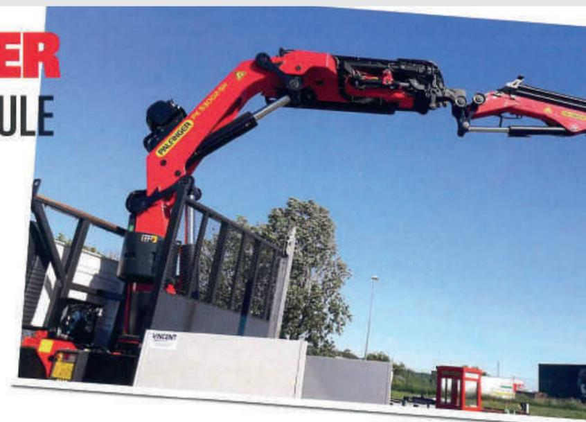
mètres et d'une capacité de levage maximale de 820 kg. Cet ensemble est complété par un Plateau Vincent avec tiroir à extension hydraulique de 2 mètres pour un confort d'utilisation optimisé. Cette grue est équipée de nombreuses technologies d'assistance pour plus de sécurité et de confort d'utilisation telles que RTC, SRC,
